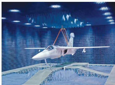
شکل ۵: نمونه هواپیمای در حال آزمون در چمبر EMC
